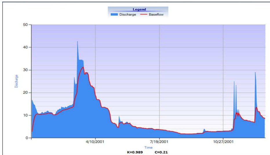
شکل ۵- نمایش گرافیکی تفکیک جریان پایه دوره خشک با استفاده از داده‌های روزانه و به روش فیلتر رقومی برگشتی دو پارامتره
